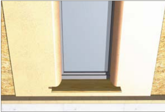
Putz auf Stroh mit runden Laibungen
